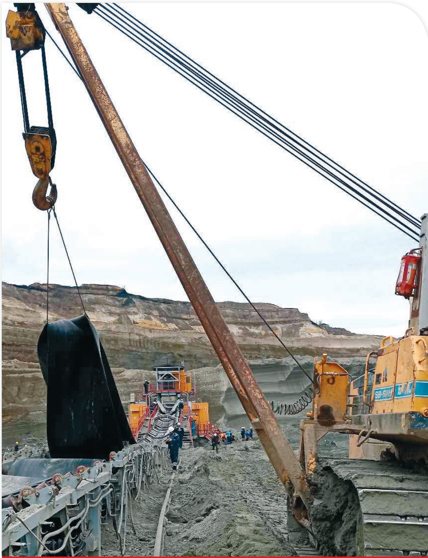
/// Фото: Мишко Волић (Конкурс) - Одржавање 124 километра трачних транспортера
